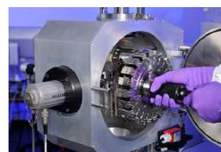
Thermal Ionisation Mass Spectrometer
